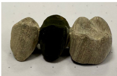
Рис. 8. Внешний вид сплава: а-покрытого Ceram Bond, б-без покрытия, в-покрытого разработанным адгезивом.
