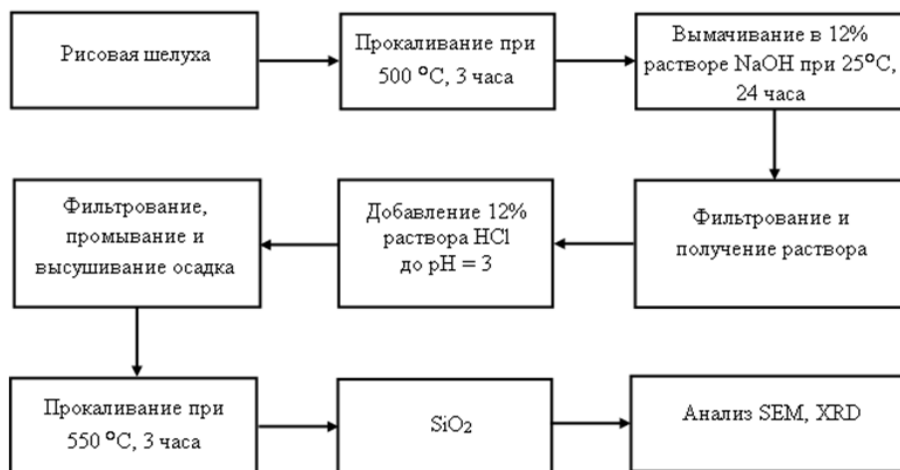
Рис. 2. Схема получения диоксида кремния из рисовой шелухи. Fig. 2. The scheme of production of silicon dioxide from rice husk ash.
