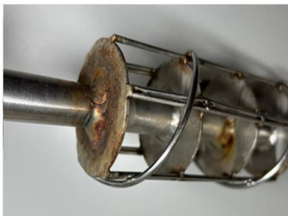
Рис. 1. Коррозионный износ с использованием абразивных частиц.
