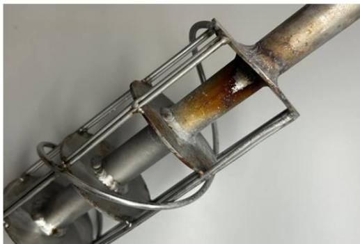
Рис. 4. Влияние искусственной аэрации и неполного погружения. Fig. 4. Effect of artificial aeration and partial immersion.
