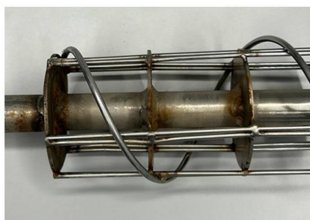
Рис. 2. Коррозионный износ с использованием абразивных частиц.
